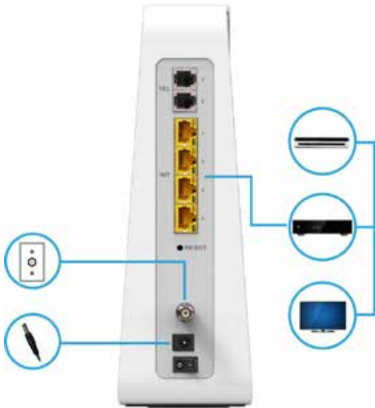
Exemple de connexion Ethernet à un orinateur (le modèle représenté est une Connect Box)
